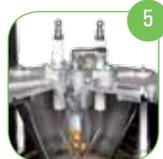
5 Узел поджига с фланцем из легкого сплава и электродами, покрытыми керамикой, разработаны IPC для **оптимизации процесса горения**.
