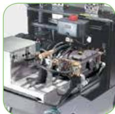
В обеих моделях - кривошипно-шатунный насос высокого давления с шестью керамическими поршнями и двумя латунными головками.
