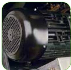
Модель H D2030Pi T оснащена 4-х полюсным электродвигателем (1450 об./мин.), модель H D1341Pi T оснащена 6-типолюсным двигателем (1000 об.мин.). Оба двигателя оборудованы термозащитой.
