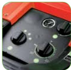
Панель управления оборудована выключателем двигателя и горелки, регулятором температуры и профессиональным манометром для слежения за давлением.
