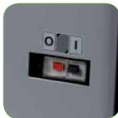
Общий выключатель с термозащитой.
