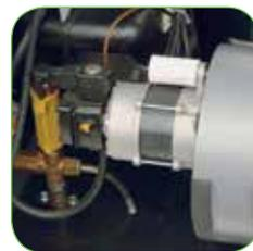
Однофазный двигатель горелки напрямую подсоединен к крыльчатке и топливному насосу (для дизельного топлива).
