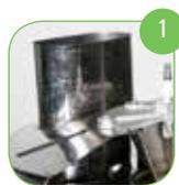
1 Выхлопная труба, наружный и внутренний резервуар из нержавеющей стали свариваются плазменной сваркой: **окисления не происходит** и бойлер служит дольше.
