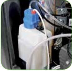
Устройство смягчения воды с насосом, управляемым с панели. Подача жидкостно-“антинакипи” регулируется в зависимости от жесткости воды.
