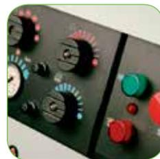
Панель управления с контролем работы насоса и горелки, термостатом, манометром, клапаном подачи пара и моющего средства, индикаторами системы "антинакипь" и датчика уровня масла, а также кнопкой аварийного выключения.
