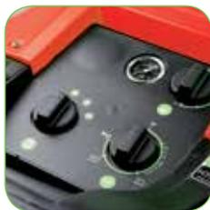
Панель управления оборудована выключателем двигателя и горелки, регуляторами температуры и подачи моющего средства, а также профессиональным манометром для слежения за давлением.
