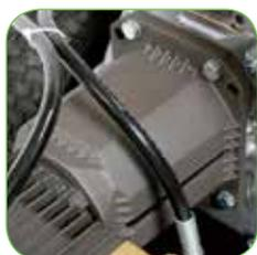
Устойчивая к вибрации муфта, соединяющая двигатель с насосом, минимизирующая вибрации, повышает надежность и срок службы всех механических узлов.
